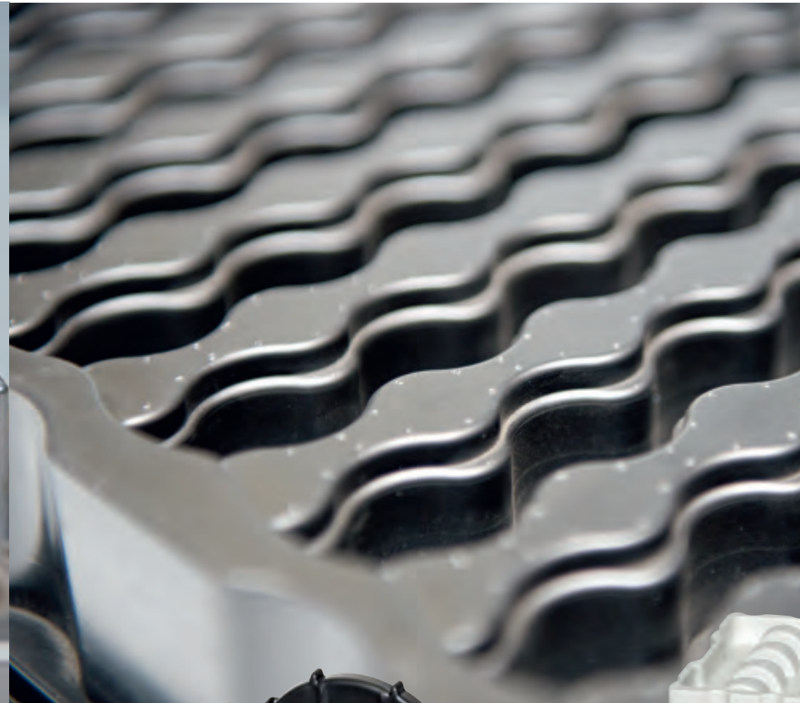
Tiefgezogene Form mit Rand. Dieser wird im nächsten Arbeitsschritt abgetrennt.
