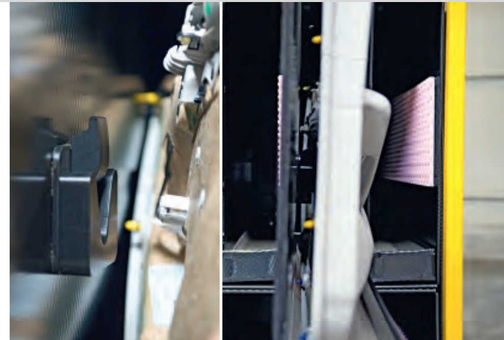
Clever gelöst: Aufhängung aus PE
