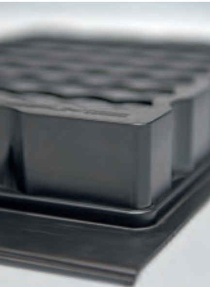
Tiefgezogene Form mit Rand. Dieser wird im nächsten Arbeitsschritt abgetrennt.
